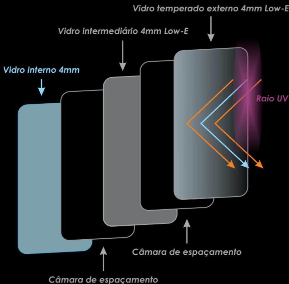
As portas da VinoBeer são feitas com três camadas de vidro sendo duas do tipo Low-E (baixa transmissão de frio/calor).
